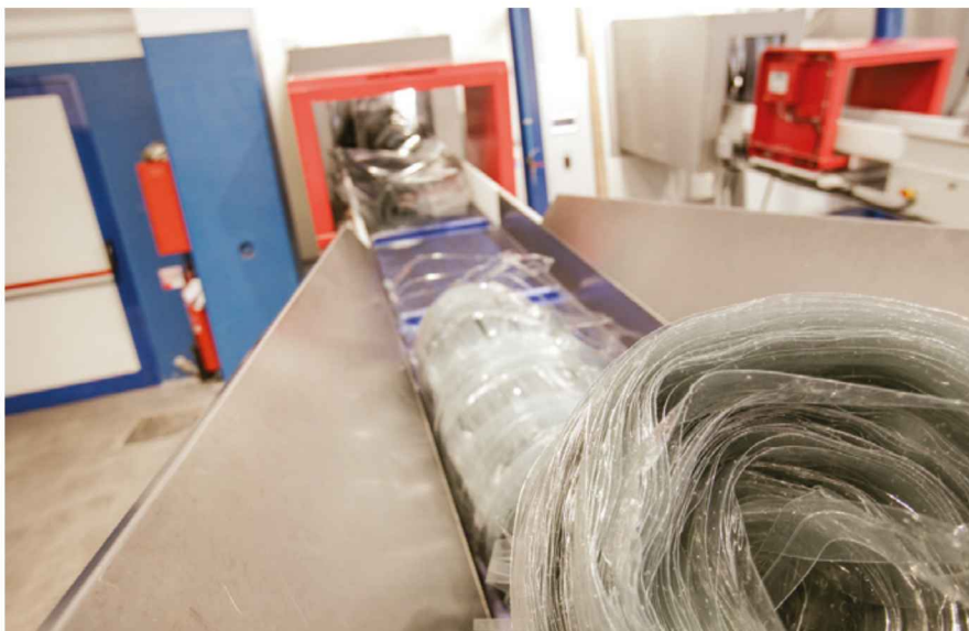
Ingresso del materiale di scarto ad uno dei mulini di macinazione plastiche (Arcoplastica).
