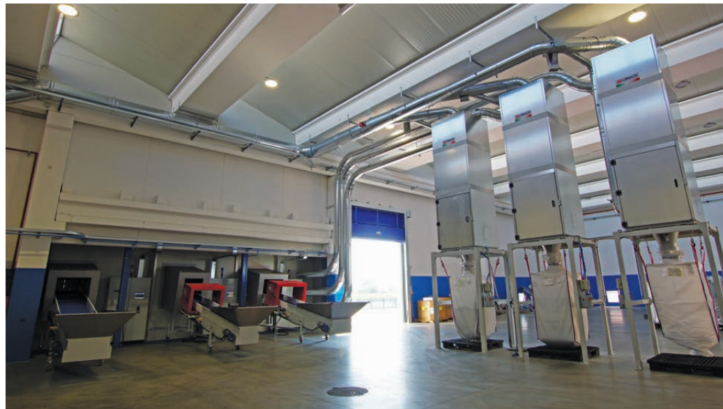
Granulatori per il recupero dei materiali di risulta a base di PET e PP installati presso Arcoplastica.
